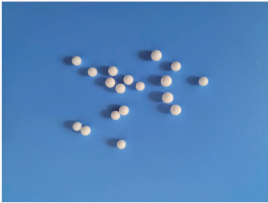
图1 滤料聚苯乙烯泡沫滤珠数码摄像
