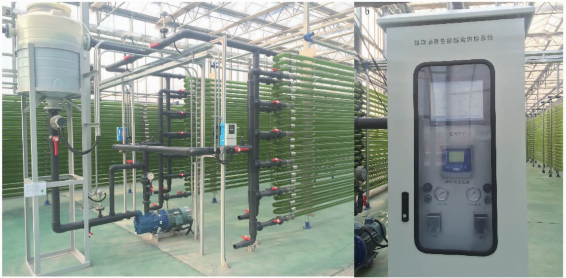
图 2 10 t 体积管道式光生物反应器(a)和微藻培养综合测控系统(b)
