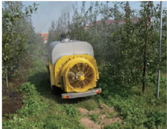
图 5 自走式风送喷雾试验样机
