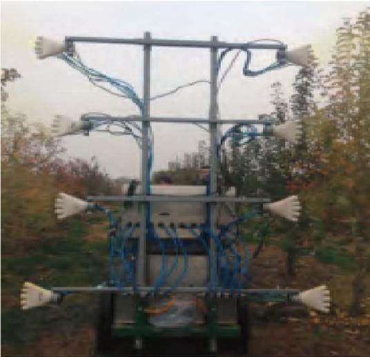
图 3 基于 PWM 信号自动变量喷药作业样机
