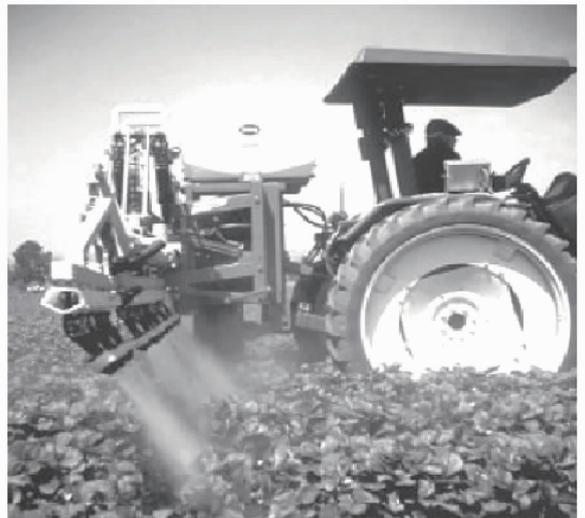
图2 气助式静电喷雾机
