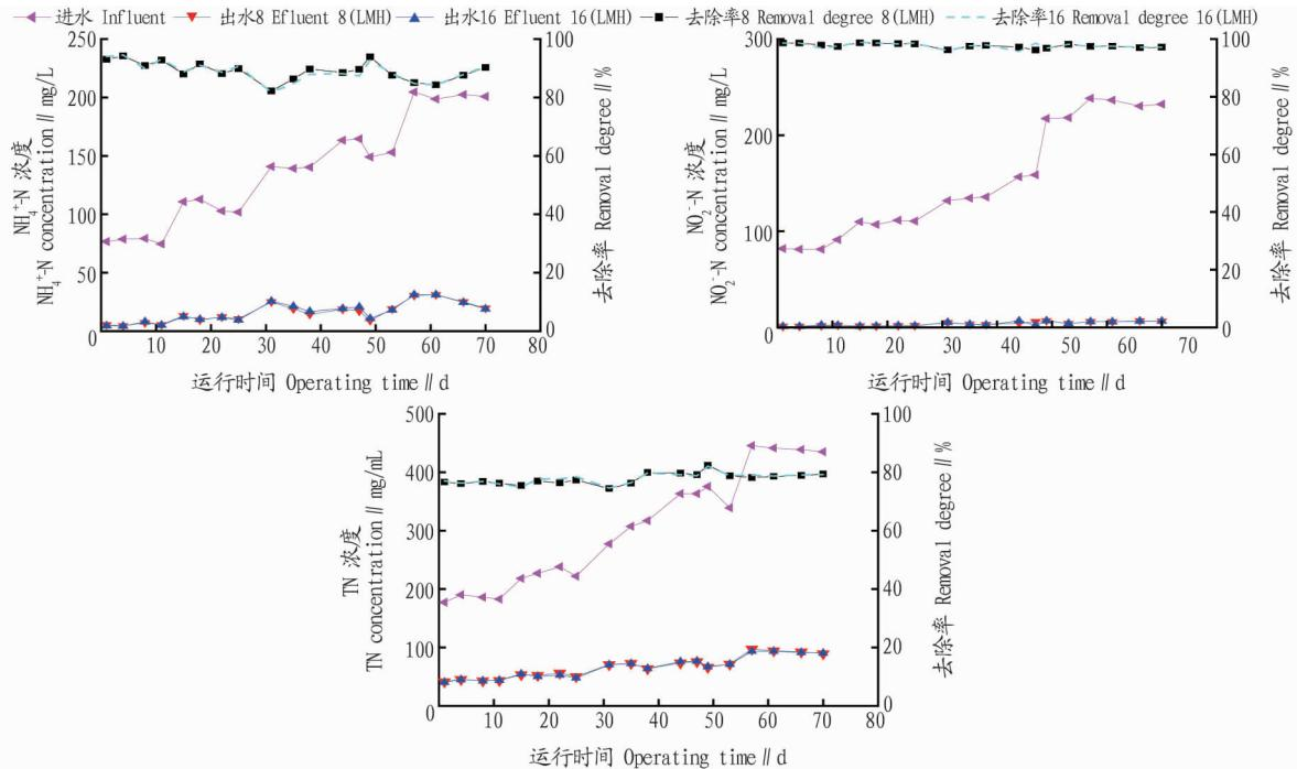
图 4 反应器运行期间进出水中氨氮、亚硝态氮和总氮的浓度变化及去除效果
