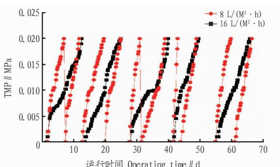
图 5 反应器运行期间跨膜压差随时间的变化
