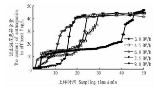
图 4 不同上样流速下红芸豆种皮花色苷动态吸附泄漏曲线
