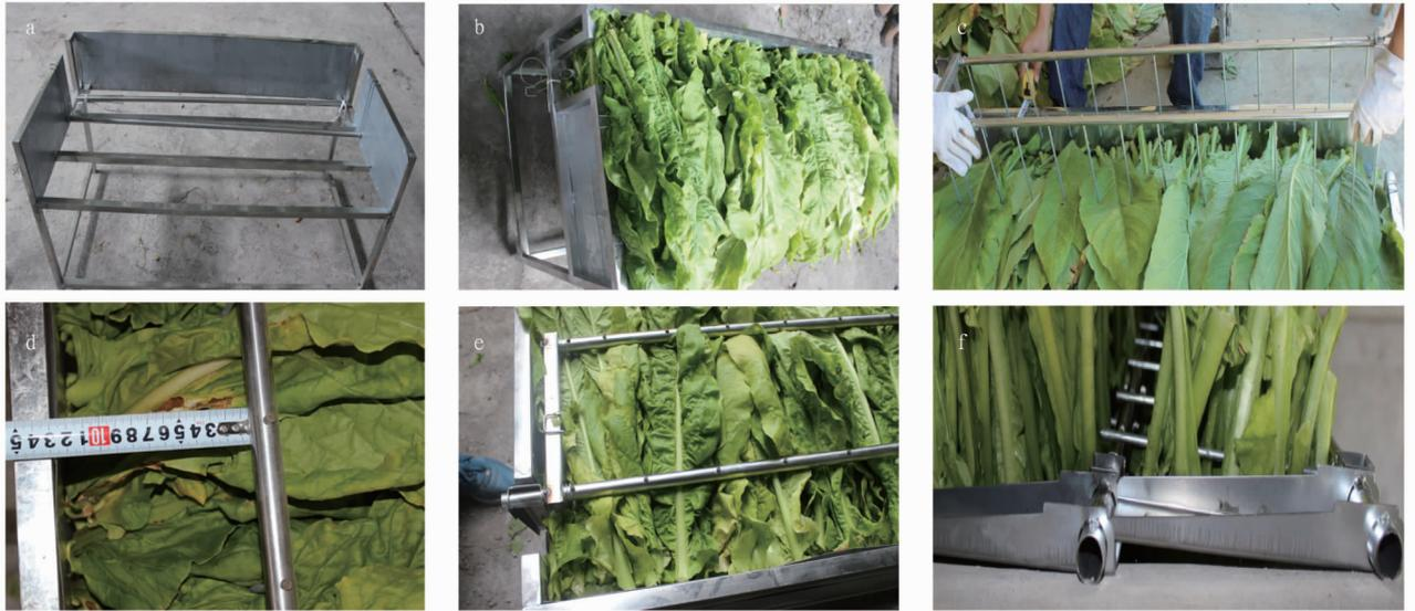
注:a.放置副支架;b.平铺烟叶;c.插入钢针;d.插针位置;e.挂钩上移;f.烟夹相叠
