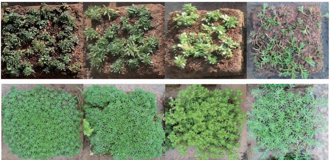
图1 多孔混凝土植被砖植生试验
