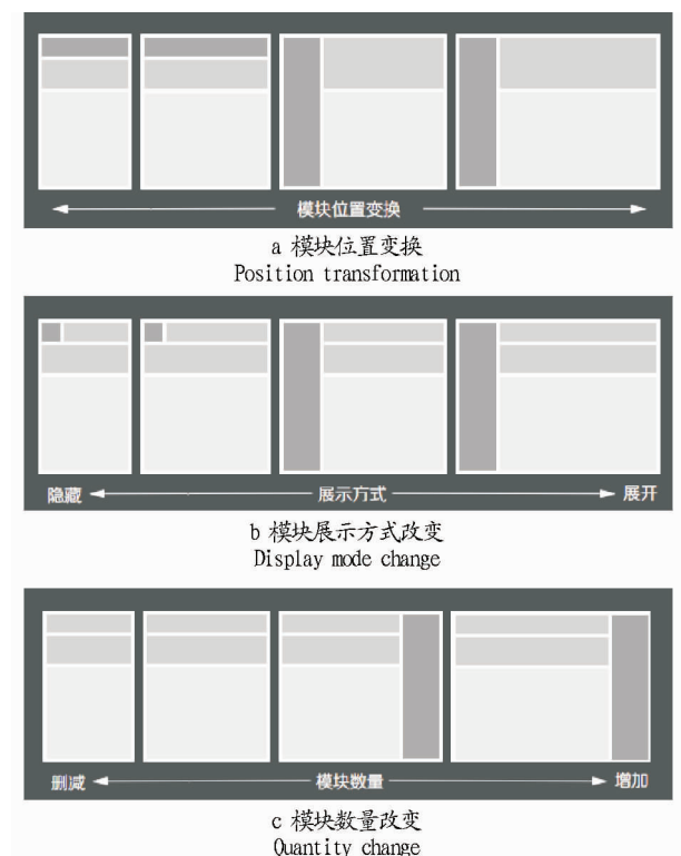
图 8 响应式 Web 整体模块布局变化示意
