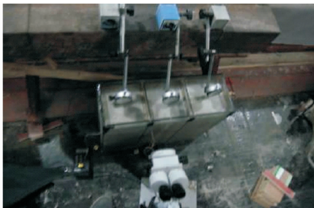
图1 盐-冻胀试验装置
