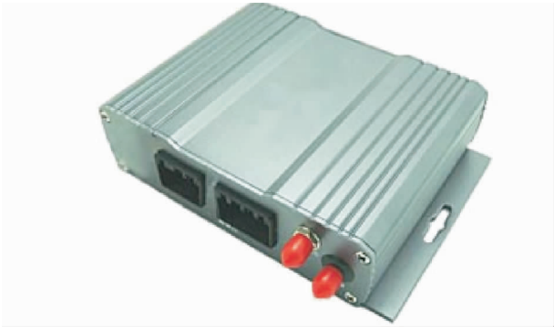
图 4 嵌入式农机车载终端
