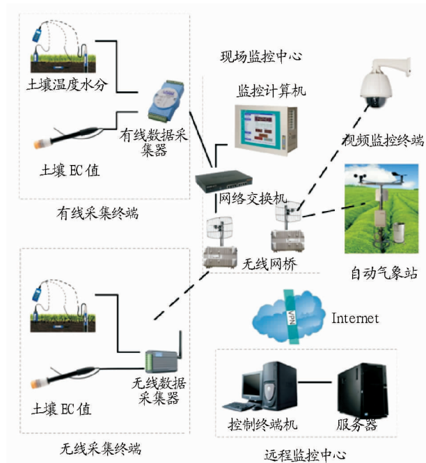
图 4 基于物联网技术的土壤环境智能监测系统
