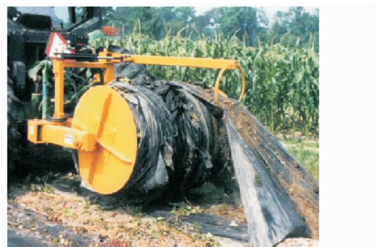
图6 收卷式残膜回收机
