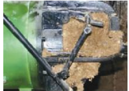
图3 螺旋压榨机排出的固渣
