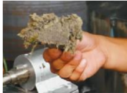
图2 从转鼓内壁挖出的固渣
